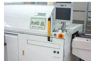
リフロー炉の更新(相模原事業所)
